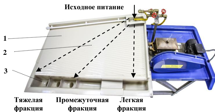
Рис. 5.1. Схема концентрационного стола 1 – дека; 2 – нарифления; 3 - сборники
