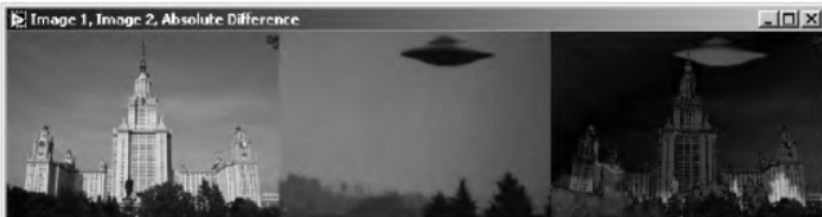
Рис. 1.2 Результат работы функции Absolute Difference
