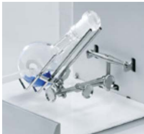
Рис. 3. Устройство ErgoClip для мерных колб на микровесах
