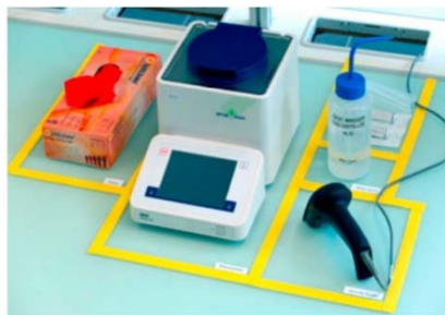
Рис. 8. Типичная рабочая станция в бережливой лаборатории. Желтая маркировка на лабораторном столе показывает точное расположение всех инструментов и материалов. Благодаря хорошей организации и стандартизации даже сотрудники с других участков могут быстро найти все необходимое.
