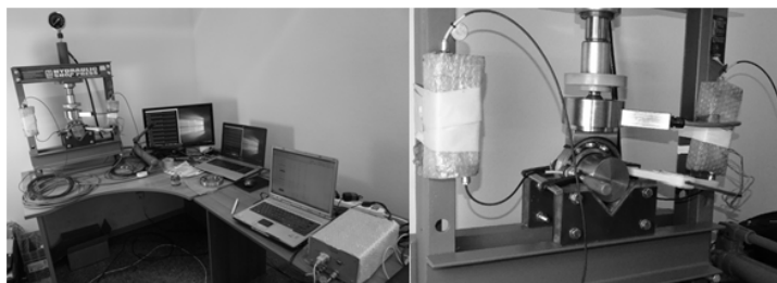
Рис. 4.6 Подшипник с искусственно созданными дефектами на наружном кольце (а), его расположение на нагружающем устройстве (б) и внешний вид экспериментальной установки (в)
