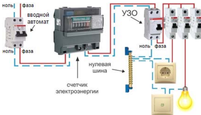
Рис. 1. Схема подключения УЗО
