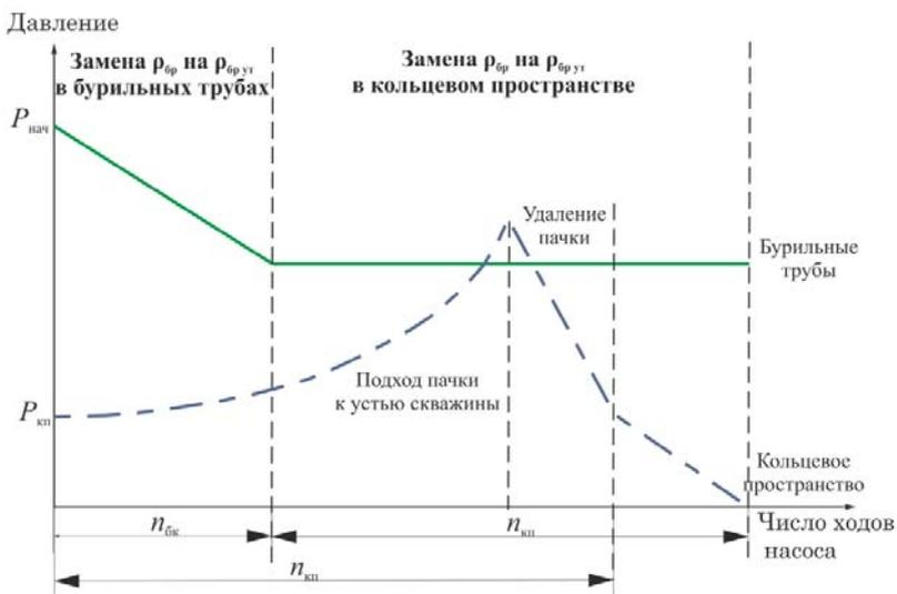
Рис. 2. График изменения давления в бурильных трубах и кольцевом пространстве при использовании способа ожидания и утяжеления
