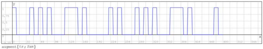
Рис. 8. Две пачки последовательности прямоугольных видеоимпульсов из 24 бит для букв КОВ
