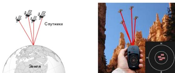
Рис.4. Плохое положение спутников и плохая радиовидимость из-за препятствий
