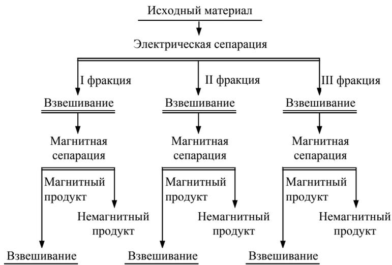
Рис.11. Схема опытов электрической сепарации
