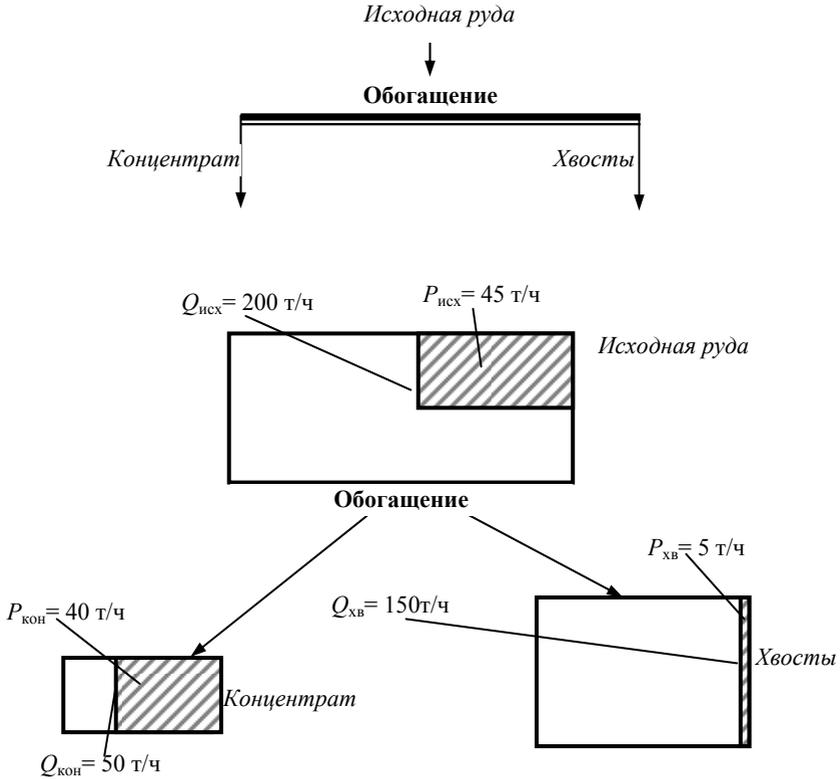
Рис. 1. Схема обогащения
