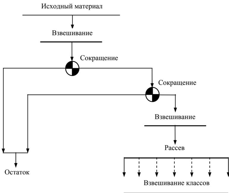
Рис.2. Схема ситового анализа
