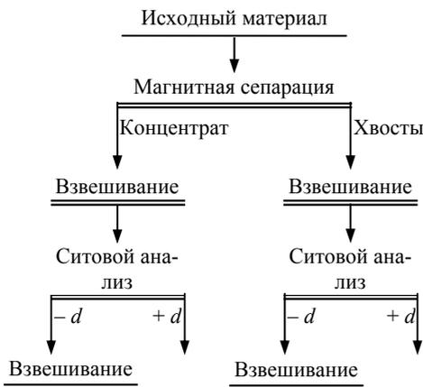
Рис.9. Схема опытов магнитной сепарации
