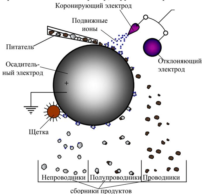
Рис. 10 Схема коронно-электростатического сепаратора
