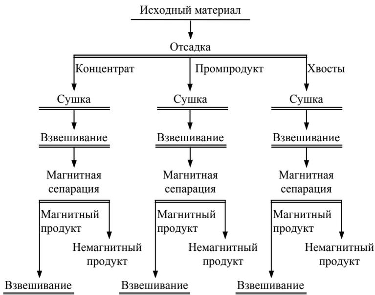
Рис.5. Схема опытов отсадки
