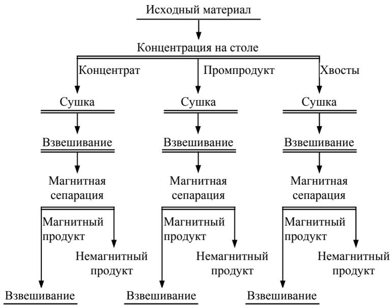
Рис.7. Схема опытов на концентрационном столе
