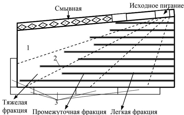
(распределение смывной воды по деке стола регулируется соответствующим положением вертушек в желобе, по которому течет вода).
