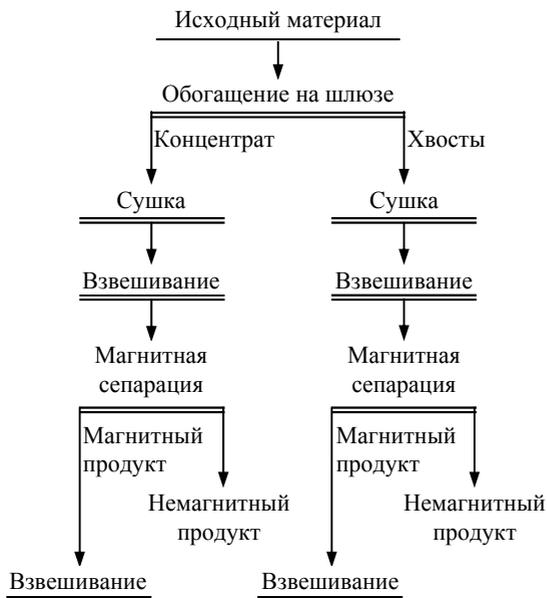
Рис.8. Схема опытов на шлюзе
