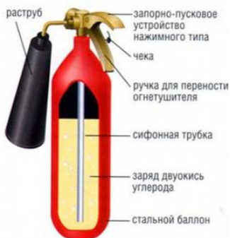
Рис. 18. Устройство углекислотного огнетушителя
