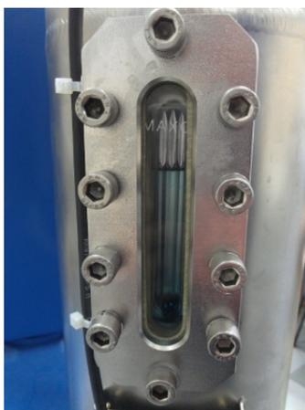
Рис.13.3. Нормальный уровень жидкости в баке для охлаждения
