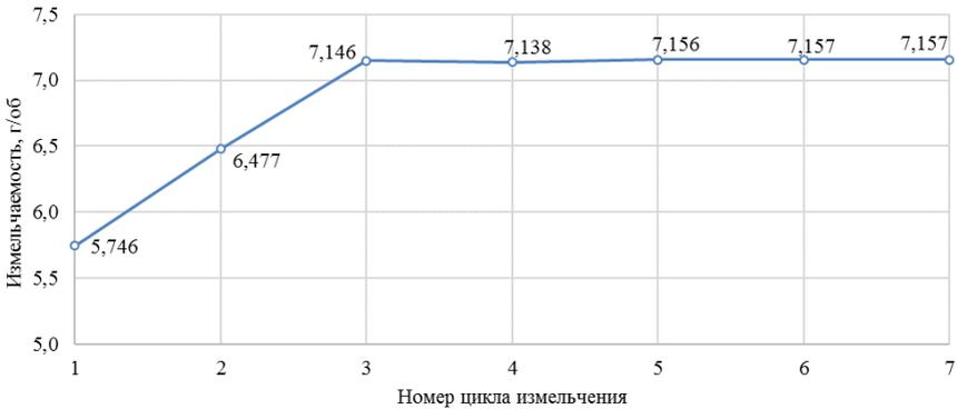
Рисунок 3.2 – График получаемой массы готового класса за один оборот шаровой мельницы Бонда, получаемой в каждом цикле измельчения
