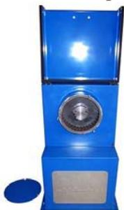
Рис.7.1 Установка для определения индекса абразивности
