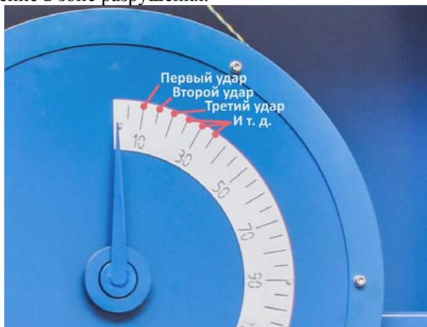
Рис. 6.3. Шкала угла отклонения маятников от вертикали (стрелка неподвижно закреплена на оси, вокруг которой вращается маятник)
