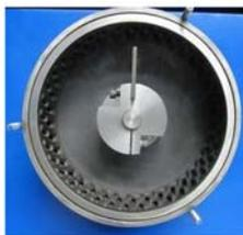
Рис.7.2 Стальная пластинка, закрепленная радиально на роторе
