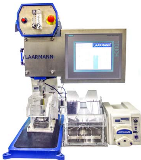
Рис. 2.1. Флотационная машина Лаарманн
