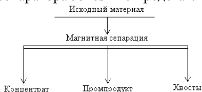
Рис.7.1 Схема опыта магнитного обогащения в высокоинтенсивном магнитном сепараторе Jones P40
