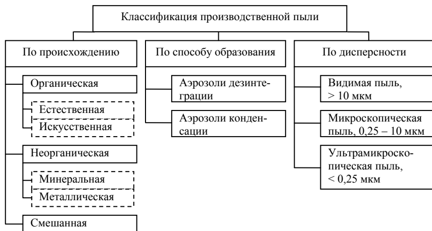
Рис. 1. Классификация производственной пыли
