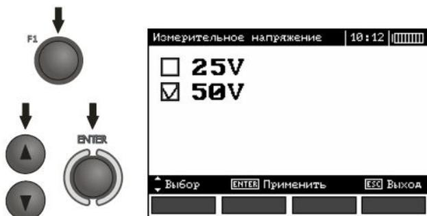
Рис. 15. Выбор измерительного напряжения
