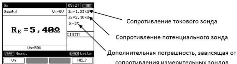
Рис. 16. Результат измерения
