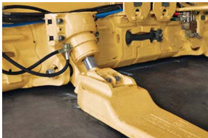
Рис.5. Гидродомкрат регулирования положения струга по почве пласта
