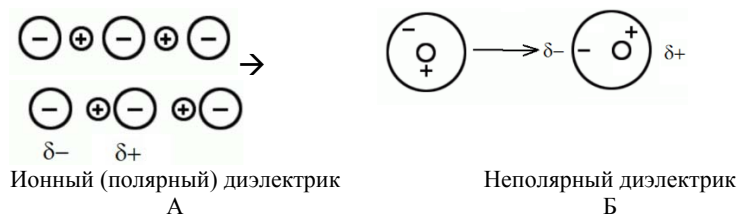
Рис. 19. Примеры поляризации диэлектриков при внесении во внешнее электрическое поле.
