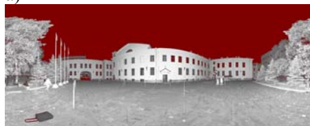
Рис. 1. Результат НЛС одной станции: а) в растровом виде; б) в виде облака точек.
