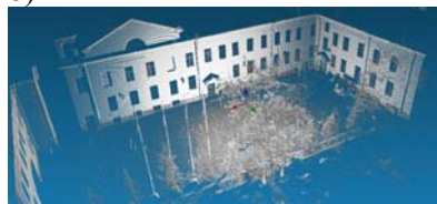
Рис. 1. Результат НЛС одной станции: а) в растровом виде; б) в виде облака точек.
