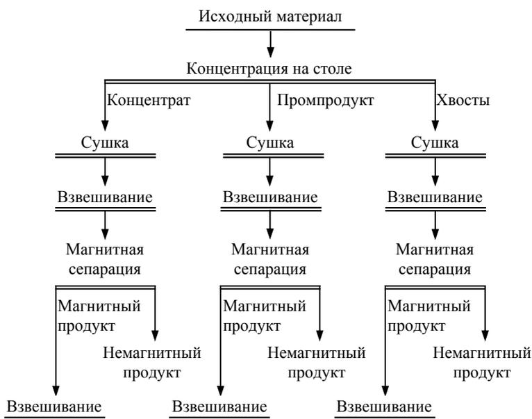
Рис.7. Схема опытов на концентрационном столе
