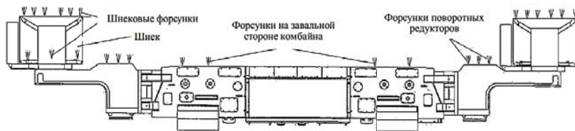
Рис.3.4. Расположение элементов системы орошения очистного комбайна на примере JOY 7LS (вид сверху)
