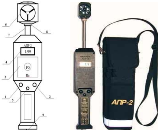
Рис.7. Схема устройства и внешний вид анемометра «АПР-2» 1,2 – кнопки управления; 3 – измерительный блок; 4 – индикатор; 5 – вывод контрольной точки; 6 – первичный преобразователь с крыльчаткой; 7 – выдвижная штанга; 8 – накидная гайка; 9 – винт отсека питания.
