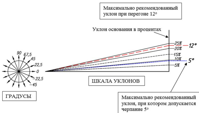
Рис.9.Измерение уклона в процентах и градусах
