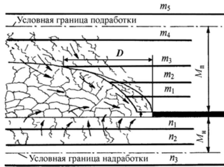
Рис. 37. Схема движения метана в выработанном пространстве очистного забоя M_n, M_n – предельного расстояния соответственно до подрабатываемых и надрабатываемых пластов-спутников; m_i и n_i – подрабатываемые и надрабатываемые пласты-спутники; D – условное расстояние от очистного забоя до i -го пласта-спутника при максимальном выделении метана из него
