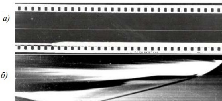
Рис.3.4. Фоторегистрограмма взрыва заряда порошкообразного тэна. а) – с зазором в плексиглазе; б) – форма и развитие процесса детонации;
