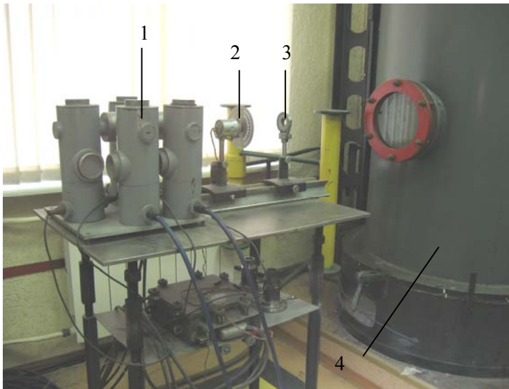
Рис. 4.4 Установка для измерения температуры: 1-фотоумножители; 2 - прерыватель светового излучения; 3- конденсор; 4-взрывная камера
