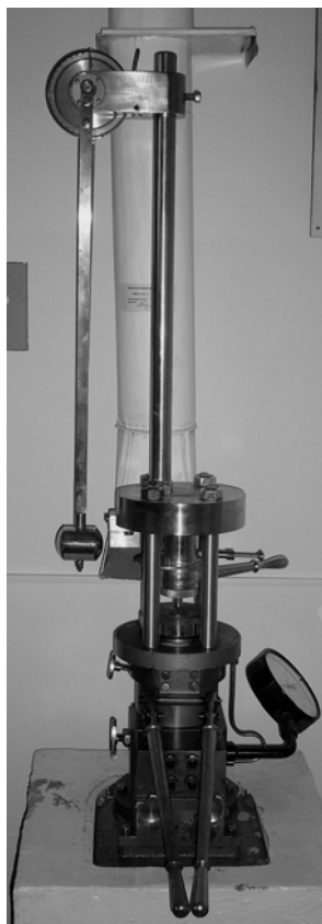
Рис. 2.1. Схема копра К-44-III и его внешний вид 1 - направляющая шпильки-ударника; 2 - шпилька-ударник; 3 - груз маятника; 4 - рычаг маятника; 5 - спусковой крючок; 6 - стойка маятниководержателя; 7 - маятниководержатель; 8 - камера; 9 - ролик; 10 - муфта; 11 - выталкиватель роликового прибора; 12 - рукоятка, опускающая муфту роликового прибора; 13 - корпус прибора; 14 - стойка прибора; 15 - пресс гидравлический; 16 - манометр; 17 - фундамент
