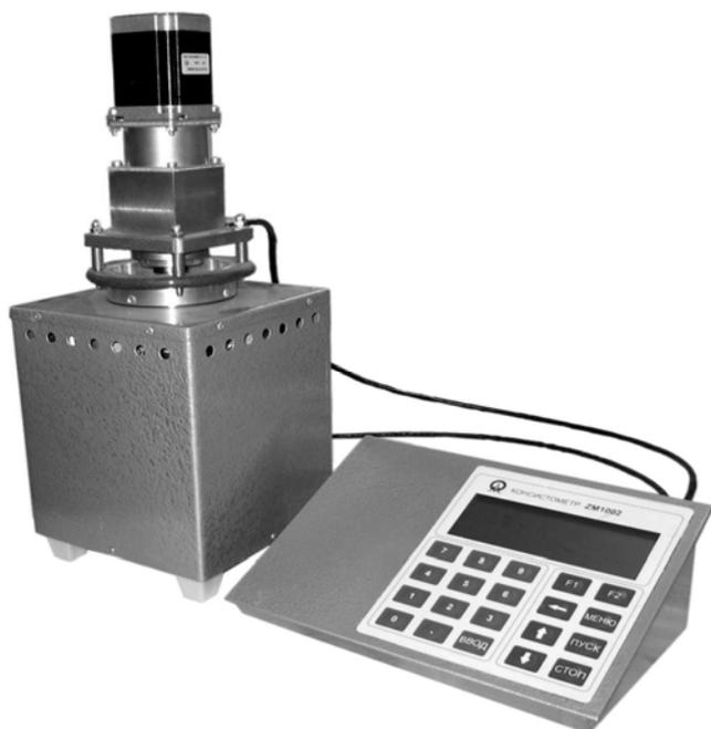
Рис. 12 Консистометр ZM1002
