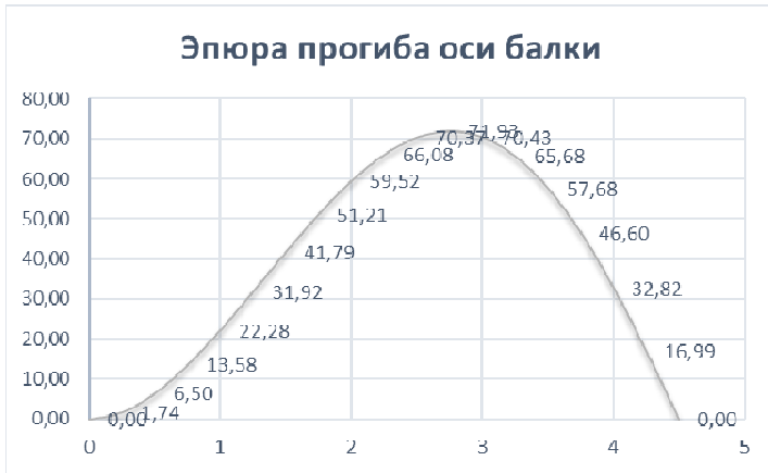
Рис. 9. Эпюра прогиба оси балки
