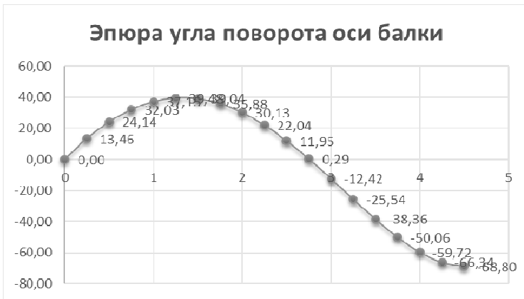
Рис. 10. Эпюра угла поворота оси балки
