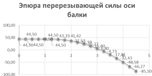
Рис. 12. Эпюра перерезывающей силы оси балки
