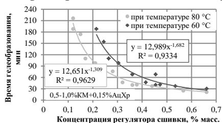
Рисунок 3 – Зависимость времени гелеобразования БПС от концентрации регулятора времени сшивки и температуры (60 и 80 °С)
