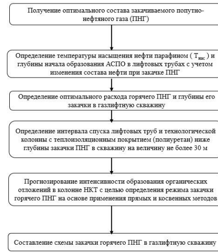
Рисунок 4 – Технология закачки горячего ПНГ (патент № RU 2755778С1): а – алгоритм последовательности технологии; б – определение оптимальной глубины и расхода закачки
