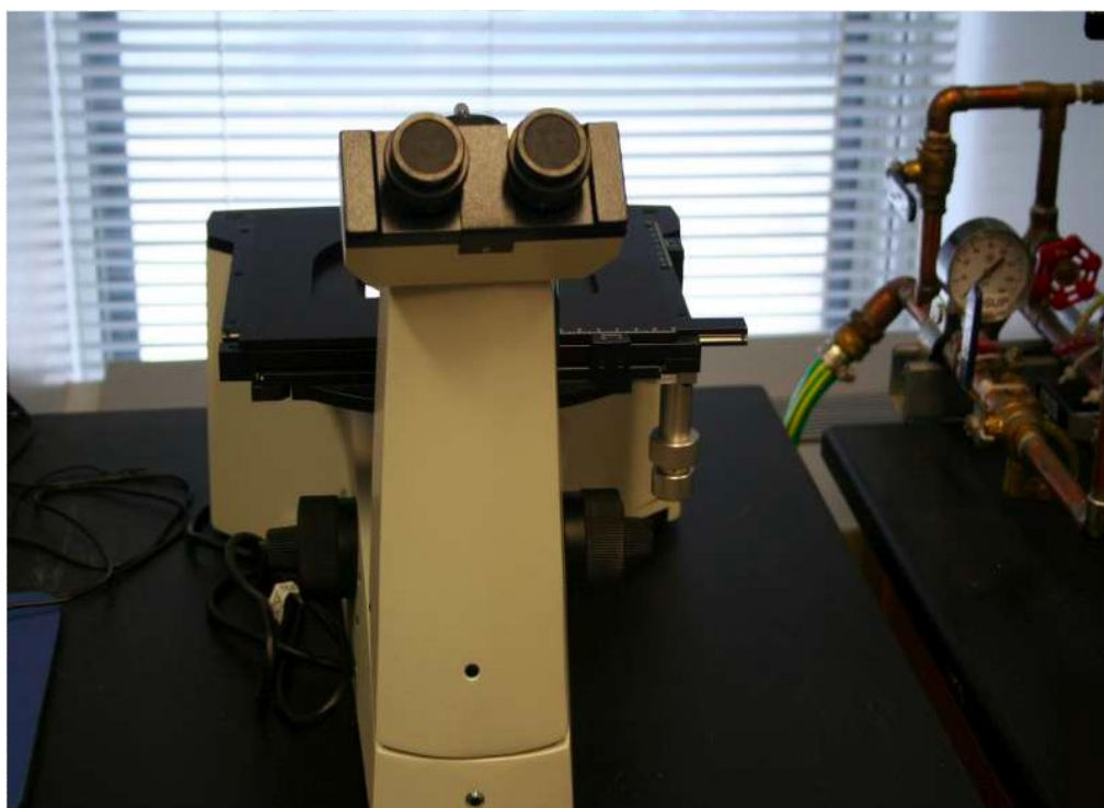
Рисунок 2.13 – Световой оптический микроскоп (LECO LX 31) соединяется с камерой (Рах cam) с программным обеспечением для анализа изображений (Рах-it)
