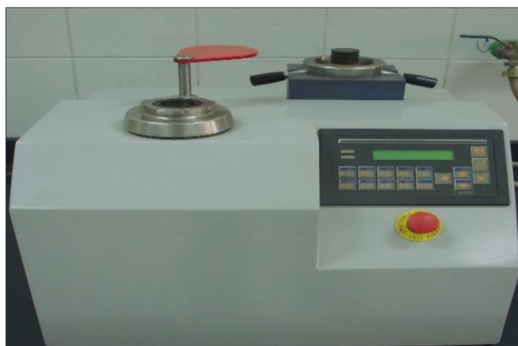
Рисунок 2.11–Горячий компрессионный монтаж образцов
