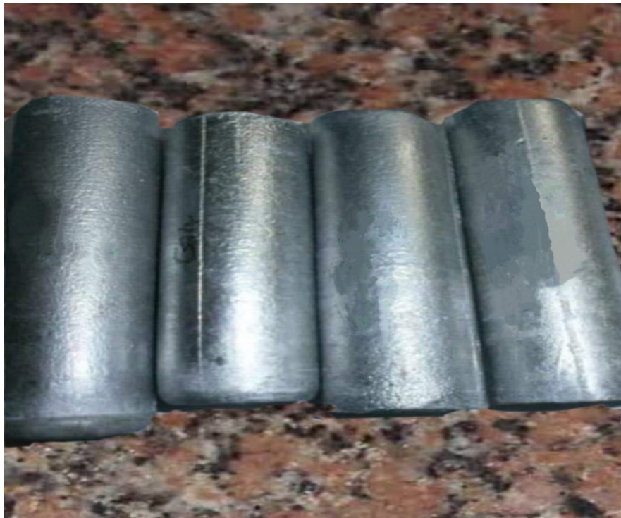
Рисунок 2.5 – Отлитый в образец сплавов с различным содержанием карбида бора, после извлечения из изложницы
