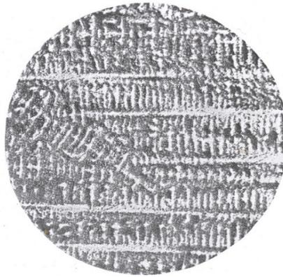
Рисунок 3.23 – Микроструктура литого медноцинкового сплава (~ 30 % Zn) [82],
