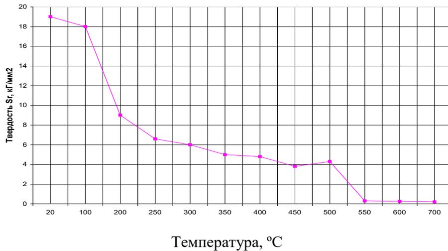
Рисунок 4.1.41 – Зависимость твердости стронция от температуры испытания [64]
