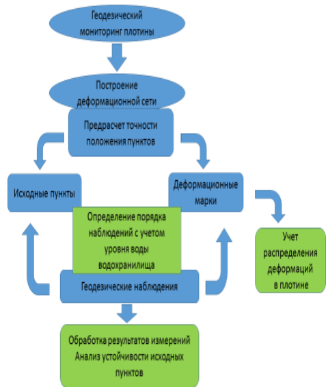
Рисунок 8 – Блок-схема геодезического мониторинга плотин
