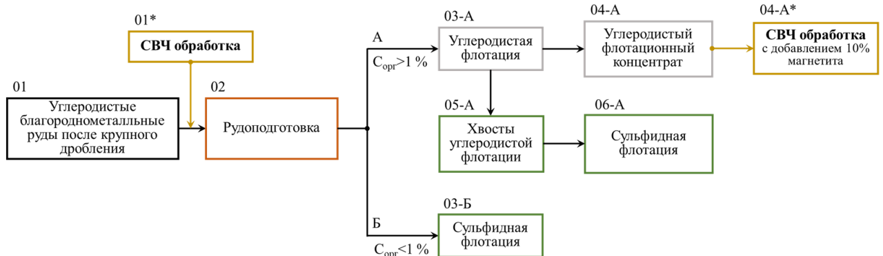
Рисунок 2.8 – Разработанный алгоритм проведения диссертационного исследования (составлено автором)
