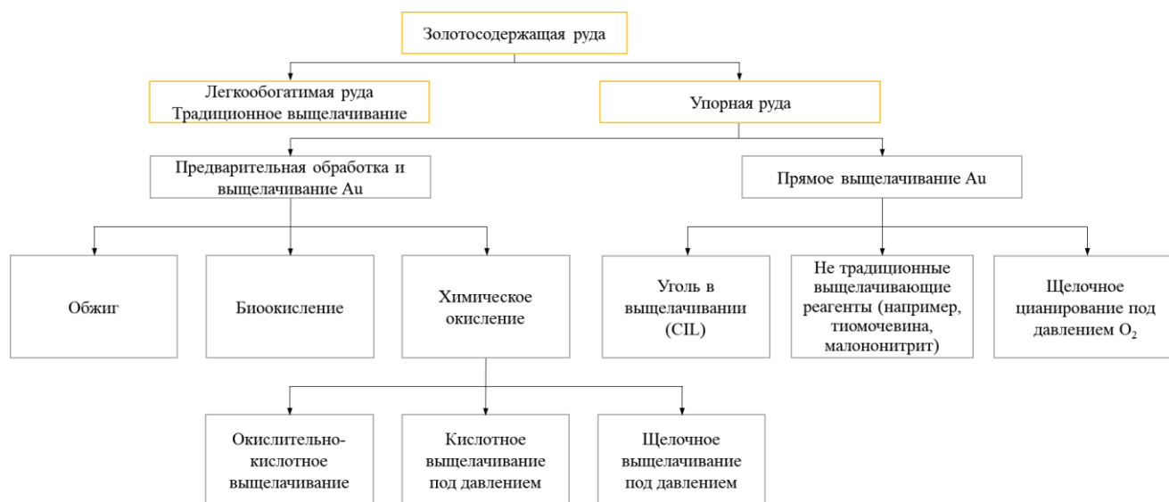
Рисунок 1.9 – Технологические подходы к переработке золотосодержащих руд [131]
