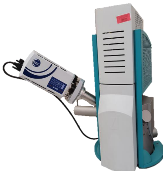
Рисунок 2.24 – Сканирующий электронный микроскоп Vega 3 LMN с системой рентгеновского энергодисперсионного микроанализа (фото автора)
