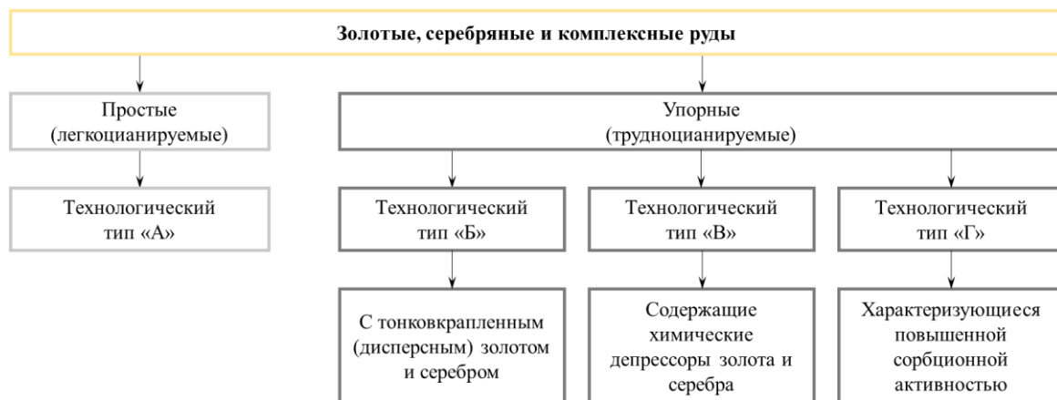
Рисунок 1.3 – Классификация благороднометалльных руд по технологическому типу упорности [33]
