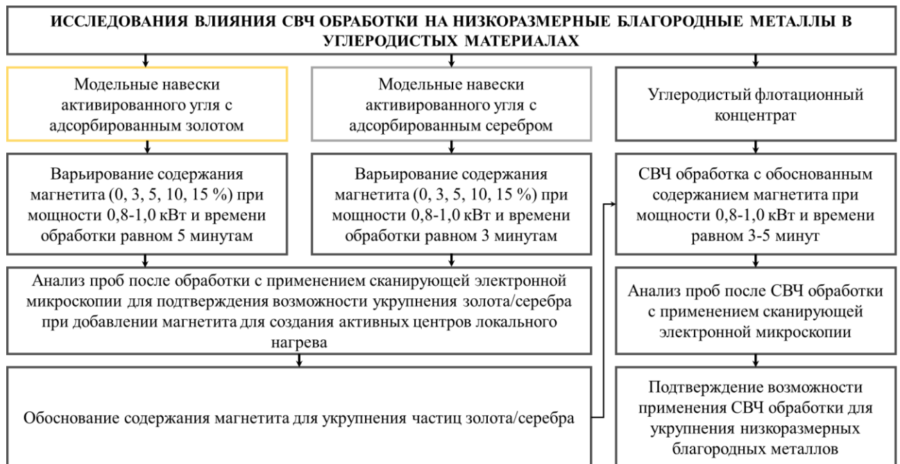
Рисунок 2.21 – План проведения исследований влияния СВЧ обработки на укрупнение низкоразмерных благородных металлов в углеродистых материалах (составлено автором)
