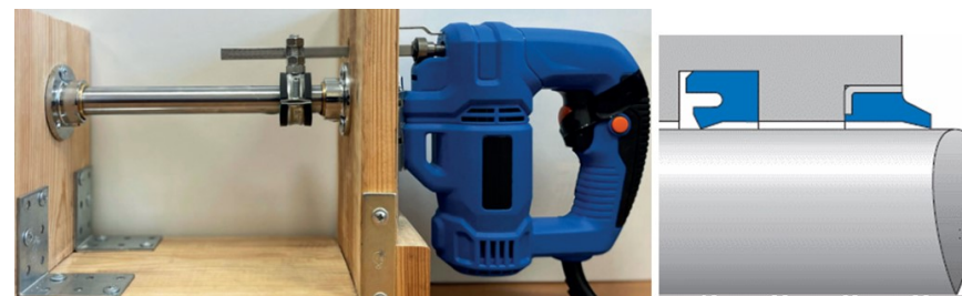
Рисунок 3 – Внешний вид лабораторного триботехнического стенда (а); установка грязесъемника и уплотнения на штоке (б)
