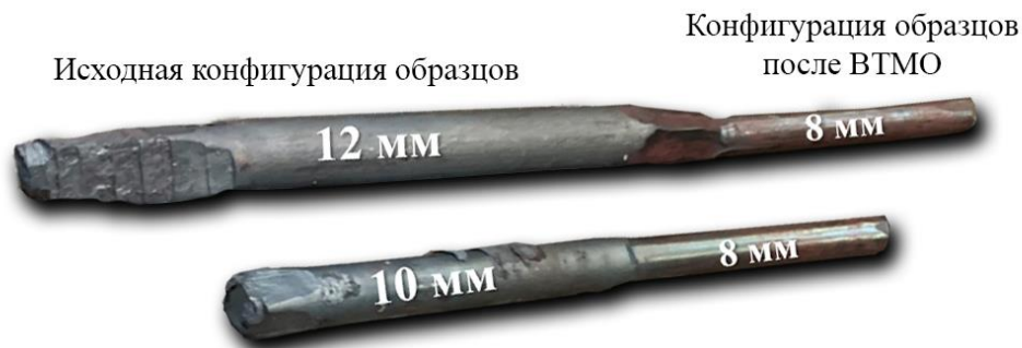
Рисунок 8 – Вид прутков после операции ВТМО
