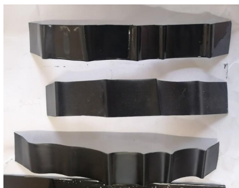
Рисунок 6 – Жестяные пластинки с эпоксидной (верхняя) и полиуретановой (средняя и нижняя) после испытаний
