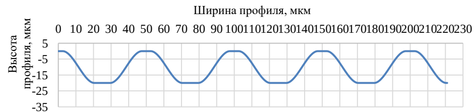
Рисунок 2 – Модель микроструктурированного профиля поверхности, формируемого лазерной обработкой по выбранному режиму
