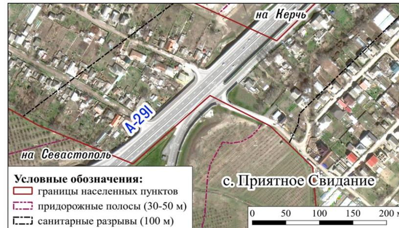
Рисунок 2 – Фактическое расположение конструктивных элементов и санитарных разрывов для автомобильной дороги (1 В)
