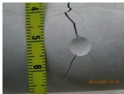
Рисунок 6 – Лабораторные исследования подготовленных образцов на одноосное сжатие сферическими инденторами: а – вид установки, б – результат испытания образца с замером
