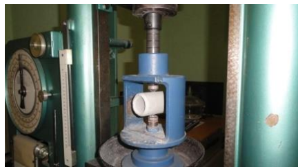
Рисунок 6 – Лабораторные исследования подготовленных образцов на одноосное сжатие сферическими инденторами: а – вид установки, б – результат испытания образца с замером
