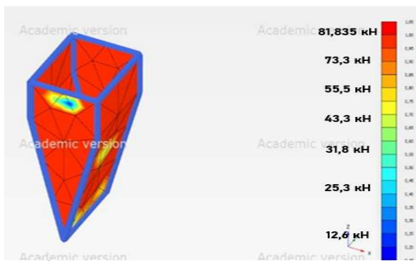
Рисунок 6 – Усилия вдавливания клина в мерзлый песок при температуре грунта – 10° С
