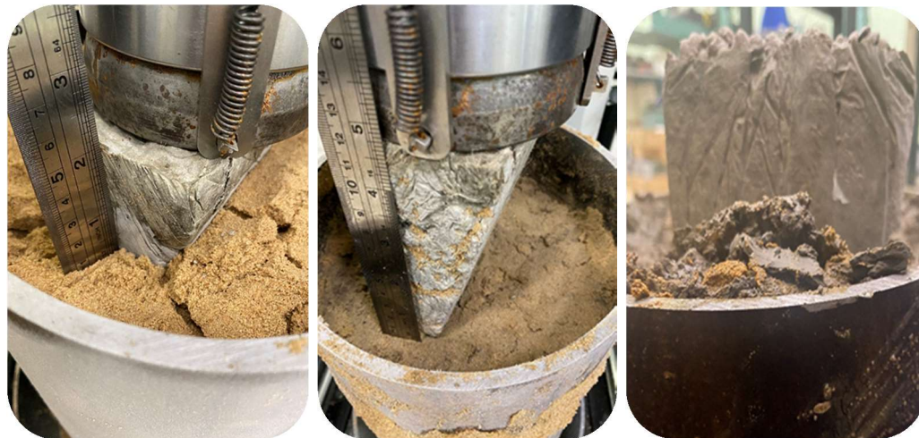
Рисунок 1 - Экспериментальный стенд для исследования зависимости величины усилия, необходимого для вдавливания клина опоры, от осевого перемещения клина в мерзлых грунтах
