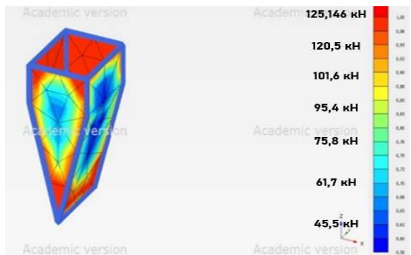
Рисунок 5 – Усилия вдавливания клина в мерзлый суглинок при температуре грунта – 10° С
