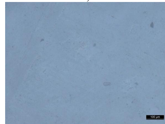
Рисунок 10 – Макрофотография участка поверхности образца после 10 циклов испытаний (а) и фотография поверхности образца после 10 циклов испытаний при увеличении x10 (б)
