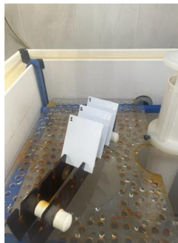
Рисунок 11 – Образцы в камере соляного тумана после испытания
