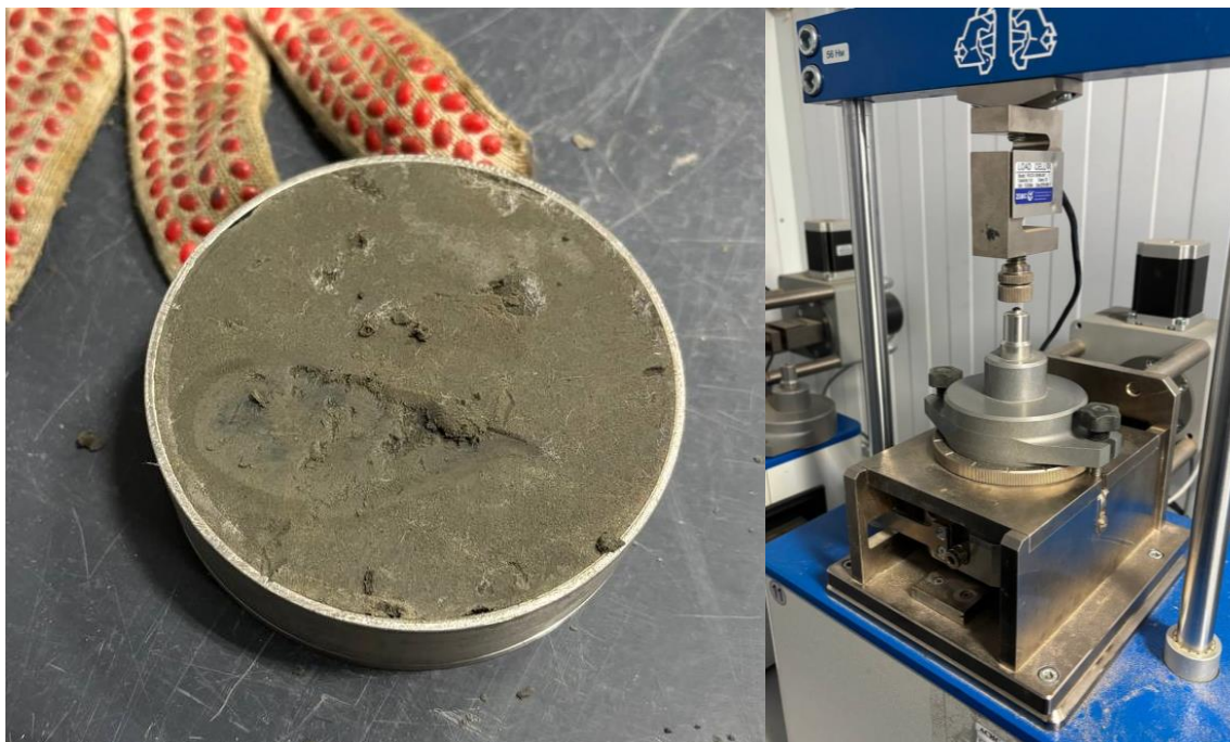
Рисунок 19 – Прибор для испытаний методом одноплоскостного среза и образец мерзлого суглинка (составлено автором)
