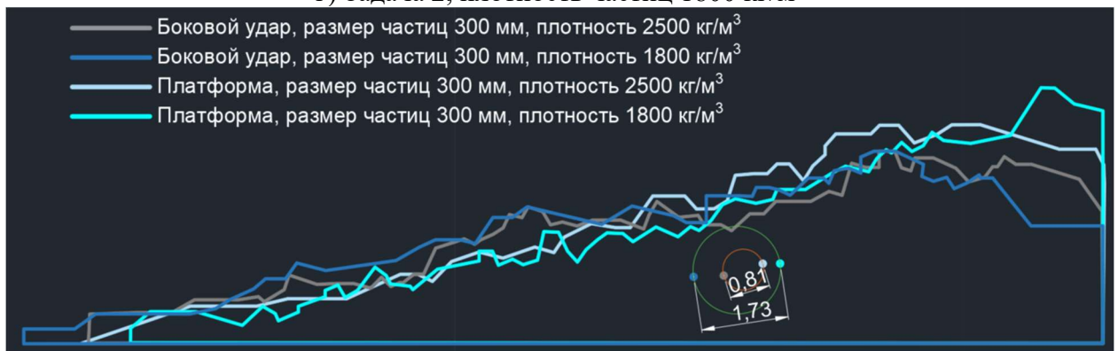
Рисунок 3.19 – Сопоставление контуров развала и центров масс (частицы 300 мм)
