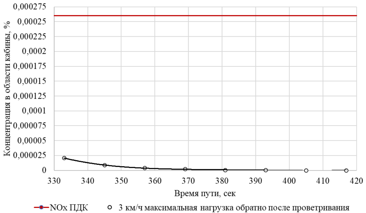
Рисунок 3.19 - Средние значения NOx в области кабины в течение времени движения машины обратно к забою со скоростью 3 км/ч после проветривания в 210 секунд при максимальной нагрузке на ДВС (составлено автором)
