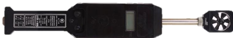
Рисунок 2.3 - Анемометр АПР-2 (фото автора)
