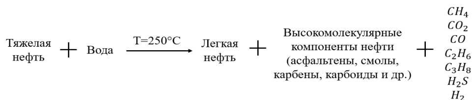
Рисунок 79 – Условная схема реакции акватермолиза, использованная в модели [составлено автором]
