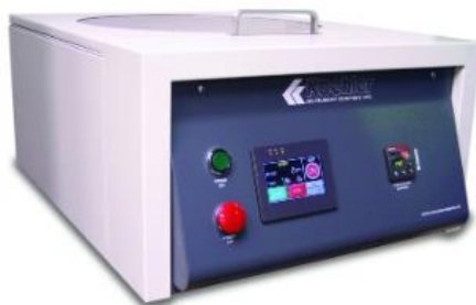
Рисунок 40 – Центрифуга К60092 для разрушения водонефтяной эмульсии [фото автора]
