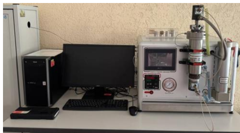
Рисунок 49 – Установка для измерения открытой пористости и абсолютной проницаемости керна ПИК ПП [фото автора]
