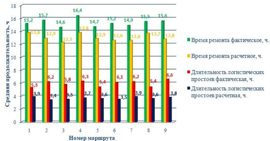
Рисунок 5 – Сравнение фактической продолжительности логистических простоев и аварийного ремонта подвесок автосамосвалов, задействованных на выбранных маршрутах, за 2023 г.с рассчитанным при помощи разработанного алгоритма
