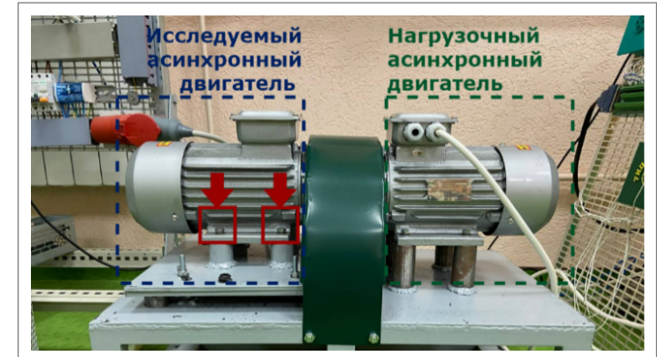
Рисунок 2 – Вид спарки исследуемого и нагрузочного АД с создаваемыми ослаблениями креплений
