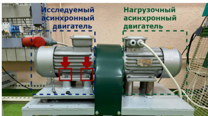
Рисунок 3.2 – Вид спарки исследуемого и нагрузочного АД с создаваемыми ослаблениями креплений
