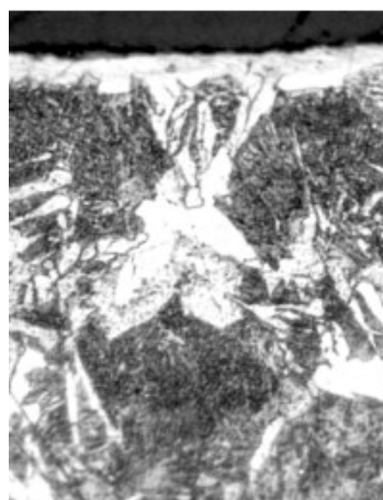
Рисунок 4.4 – Микроструктура никелевого покрытия на стали 45 при использовании \text{CaO-Li}_2\text{CO}_3\text{-B}_2\text{O}_3 ( 950^\circ\text{C} , 4 ч) \times 200
