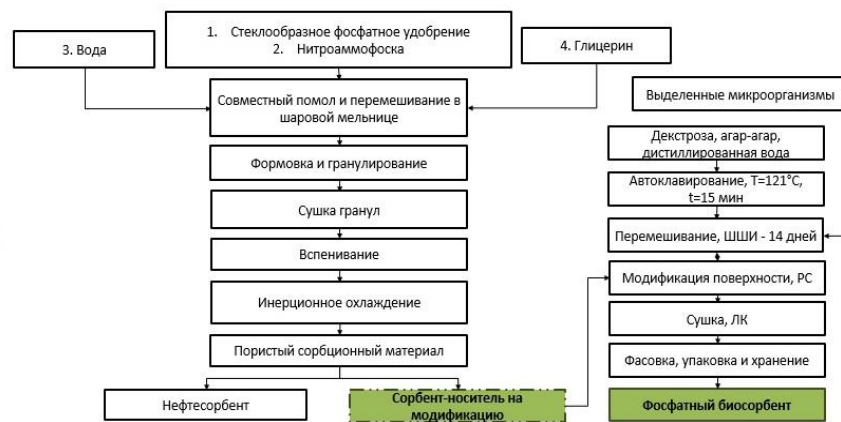
Рисунок 5.1 – Блок-схема получения носителей и биосорбентов на их основе
