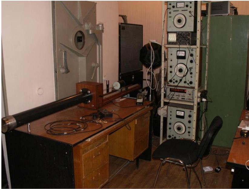
Рисунок 5 – Экспериментальный стенд – труба Кундта
