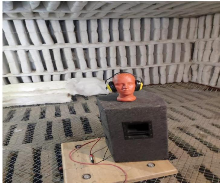
Рисунок 7 – Экспериментальный стенд с искусственной головой
